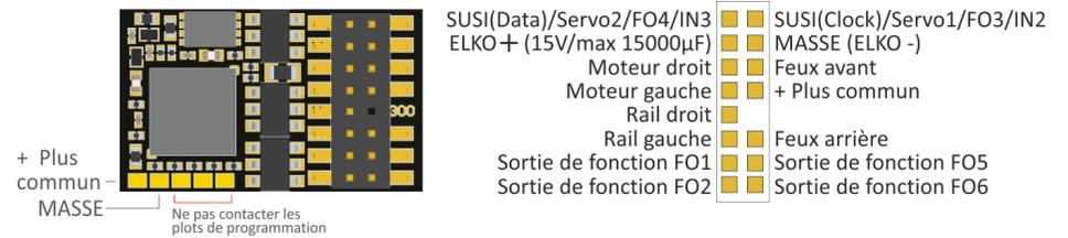
Schéma de connexion **MN300 câblé**
