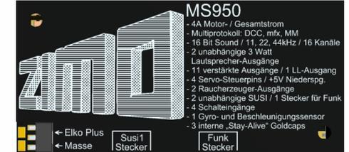
MS950 + plaque de base: connexion ELKO-plus et MASSE visible
