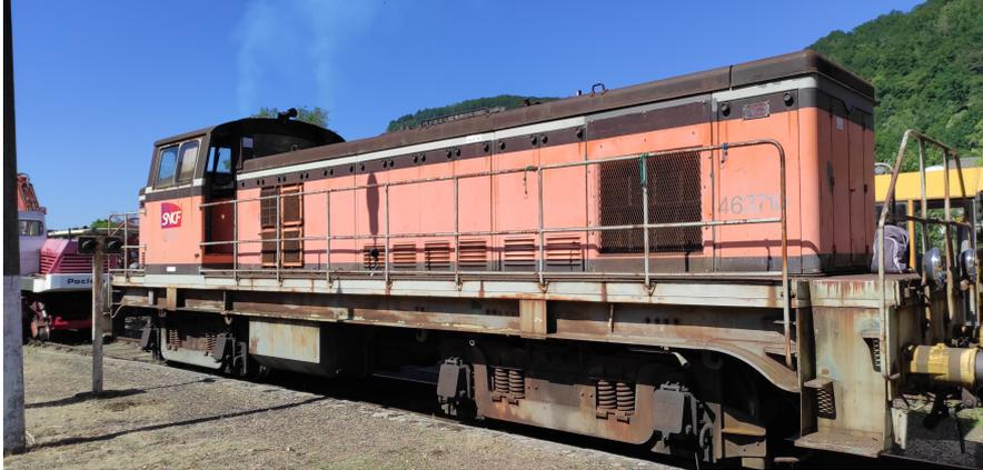
Les BB 63500 sont des locomotives diesel de la SNCF, similaires aux BB 63400. Elles reprennent, avec quelques différences mineures, les caisses des BB 63000, faisant ainsi partie de l'importante famille des BB Brissonneau et Lotz.
