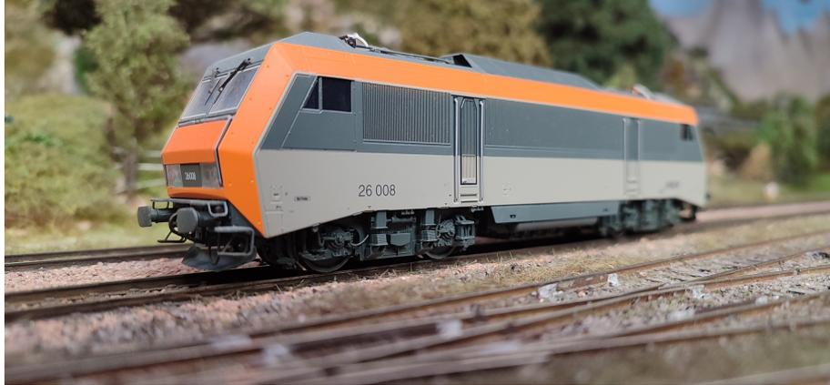
Les BB 26000 sont une série de locomotives électriques de la SNCF, surnommées « Sybic » contraction de « Synchrones » et « Bicourant ». Après la livraison en 1986 des dernières BB 22200, la SNCF s'apprête à recevoir une nouvelle série de locomotives bicourant universelles, c'est-à-dire capables de tracter aussi bien des trains de voyageurs rapides à 200 km/h que des trains de marchandises lourds.
