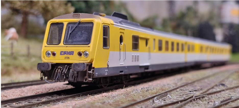
Dérivés des RGP 2 X 2700 sur le plan structure et des X 2800 pour la partie mécanique, les ensembles ferroviaires monomoteurs dits Rame à grand parcours RGP 1 ont comporté deux variantes :
