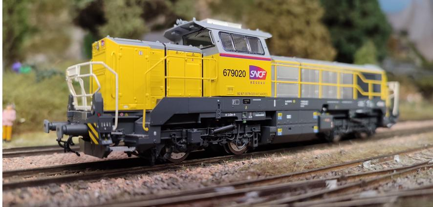
La Vossloh DE 18 est une locomotive Diesel de Vossloh Locomotives construite depuis 2010. Elle développe une puissance maximale de 1 800 kW et atteint une vitesse maximale de 120 km/h. Elle est commandée en 2016 par Akiem pour remplacer les BB 67200 de SNCF Réseau sous la désignation de BB 79000.
